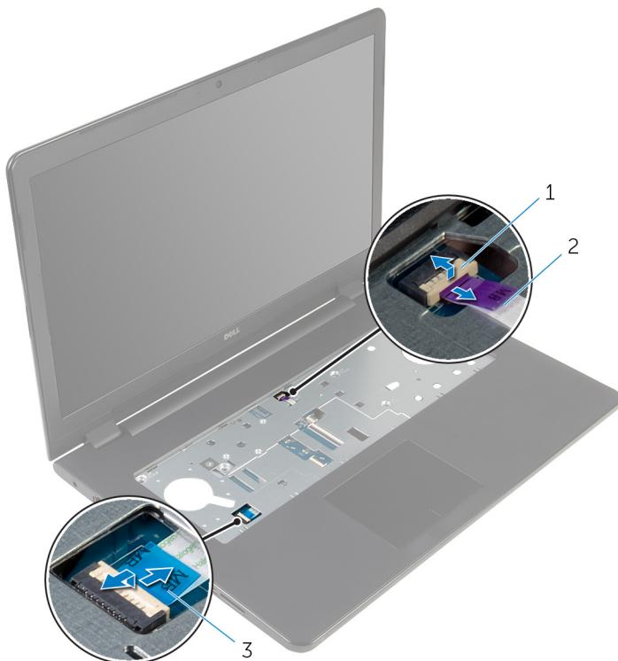
1 Kabel plošče gumba za vklop
